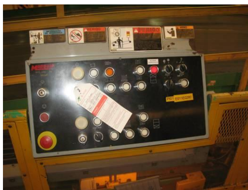
Sistema de cartões de manutenção
