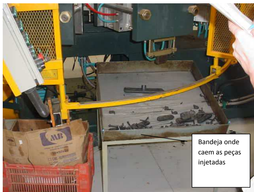
Detalhe da bandeja onde caem as peças injetadas pela máquina
