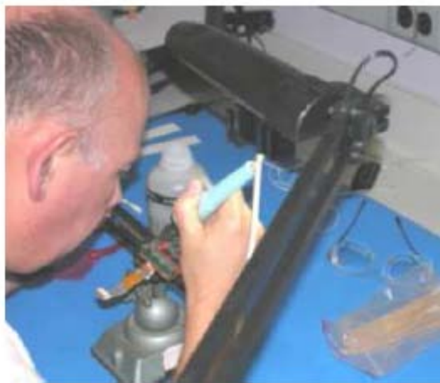
Figura 23. Recuperação do flat cable, SSCVR, PR-GTD
