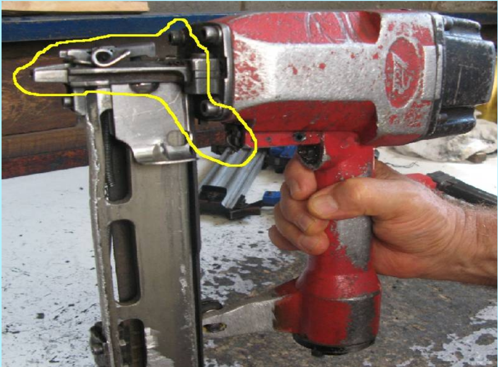
Foto 17- Grampeador sem proteção.
