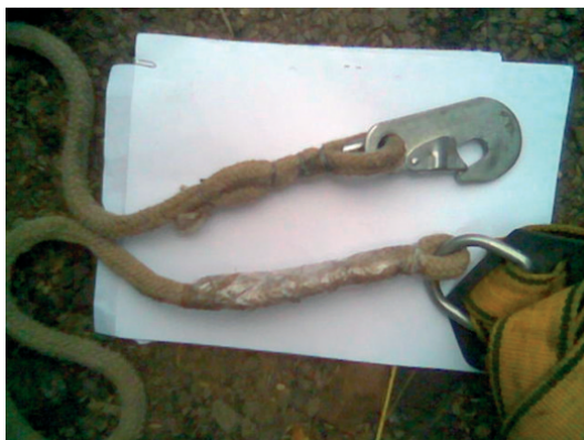
Figura 1: Talabarte ligando o cinto de segurança tipo pára-queda até o gancho de fixação ao cabo guia. Notar que a corda original se perdeu e foi substituída por outra, amarrada com arame e fita adesiva. Este equipamento danificado, absolutamente impróprio para uso, foi fornecido ao trabalhador
