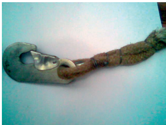
Figura 2: Talabarte do cinto de segurança tipo pára-queda próximo ao gancho de fixação ao cabo guia, “consertado” com arame e fita adesiva. A fita adesiva foi removida para permitir esta foto. Este equipamento danificado é absolutamente impróprio para uso e deveria ter sido substituído imediatamente
