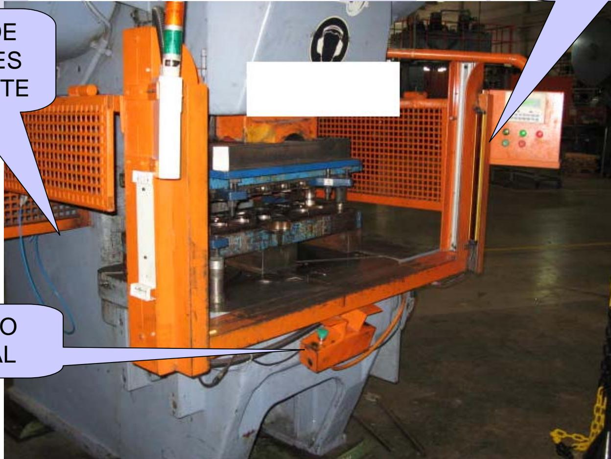
**Máquina aparentemente protegida com uso de cortina de luz e bi manual. Grades de proteção laterais insuficientes para impedir acesso dos membros superiores à zona de prensagem**
