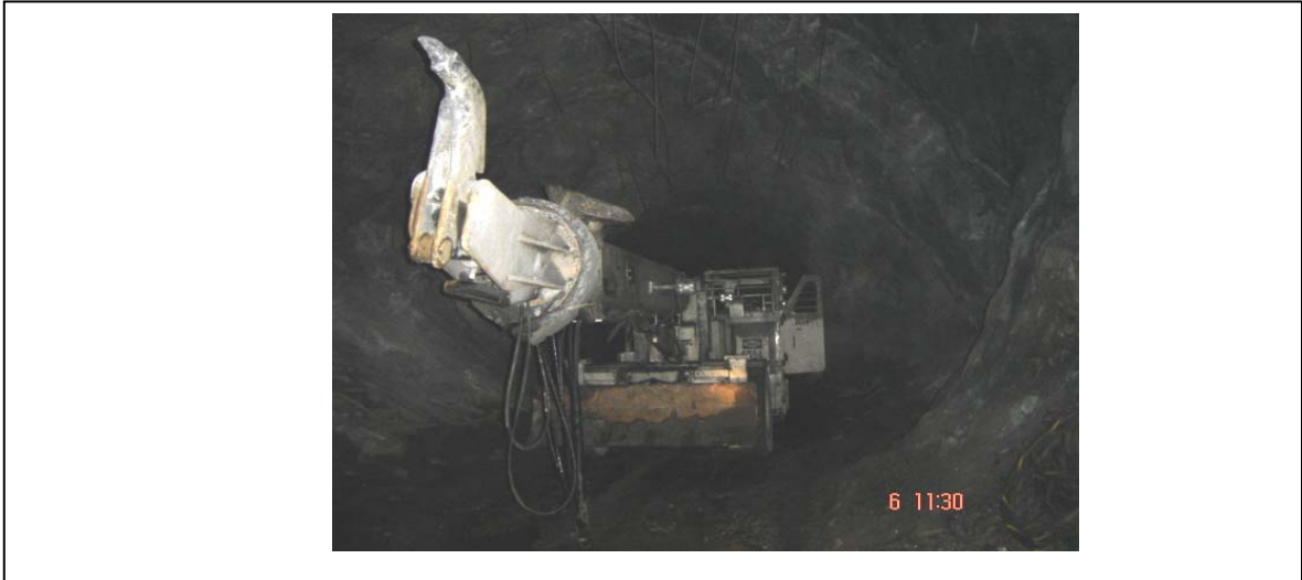
Fotografia de detalhe da alavanca de scaler em operação na mina subterrânea de ouro estudada. Fonte: Arquivo pessoal
