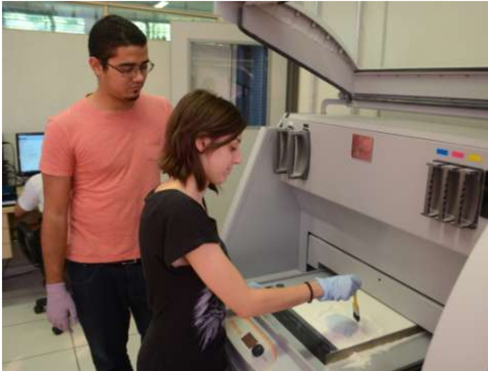
Figura 3: modelo sendo retirado da impressora 3D. Observe a placa azul que é o modelo do implante recém construído.
